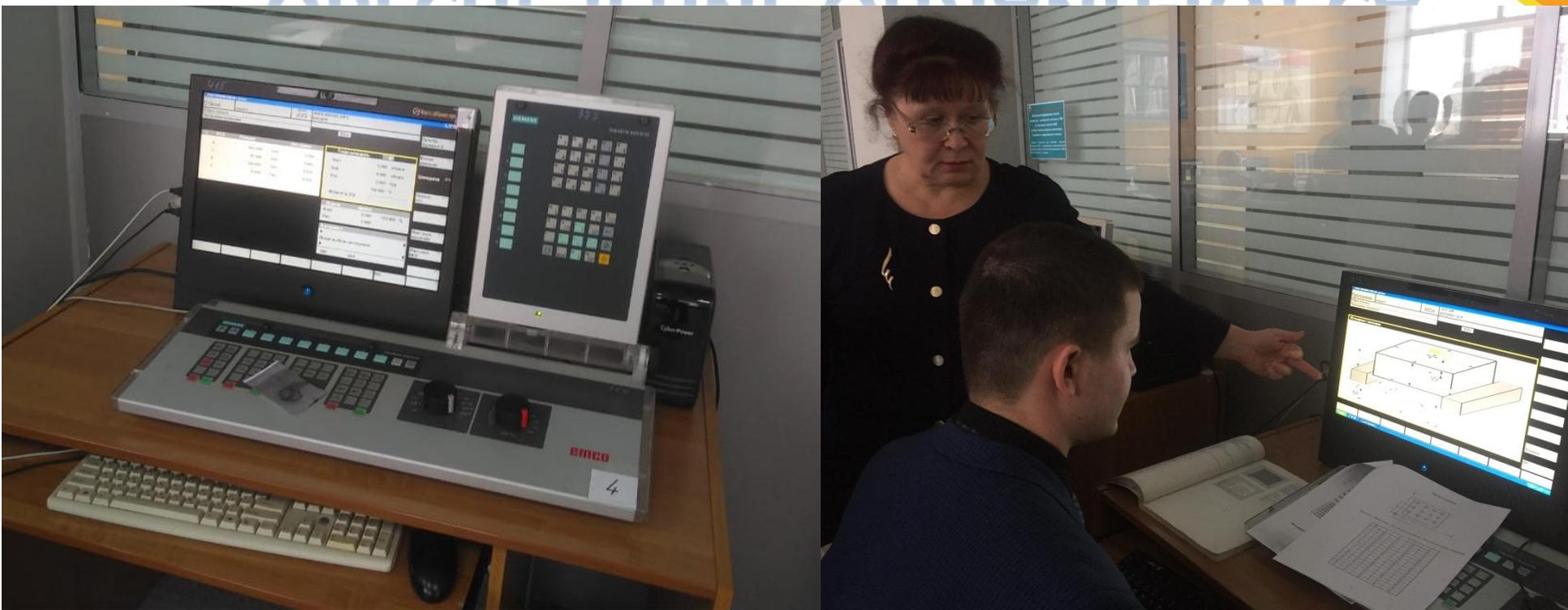
**Базовое устройство для установки сменных клавиатур ЧПУ с селекторными переключателями режимов и подачи Board Control**
